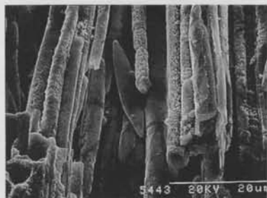
2) 鉄 (Fe) 化合物の拡大写真 (×1500)
