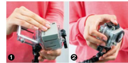
**【作り方】** ①GoPro本体を付属の防水ケースにはめる ②GoProのアタッチメントを使い、棒の先端の方に取り付ける
