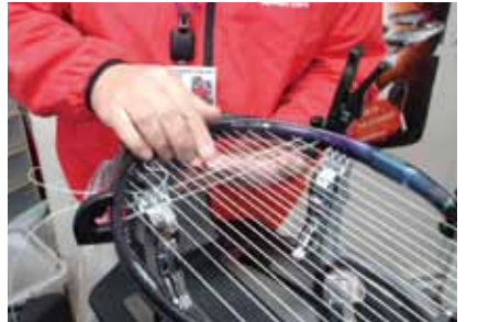
鮮やかな手つきで、横糸を縦糸の上下に通してゆく。手前の横糸を固定しているのがクランプ。
