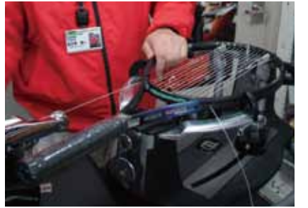
縦糸を張る様子。左側のシルバーの部品にガットを引っ掛け、ボタンを押すとテンションがかかる。
