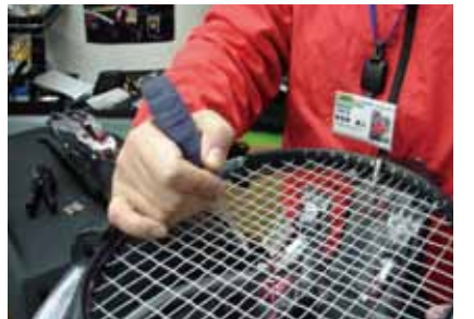
専用の工具でガットの目を整える作業。見た目の美しさもガット張りの大切な要素。
